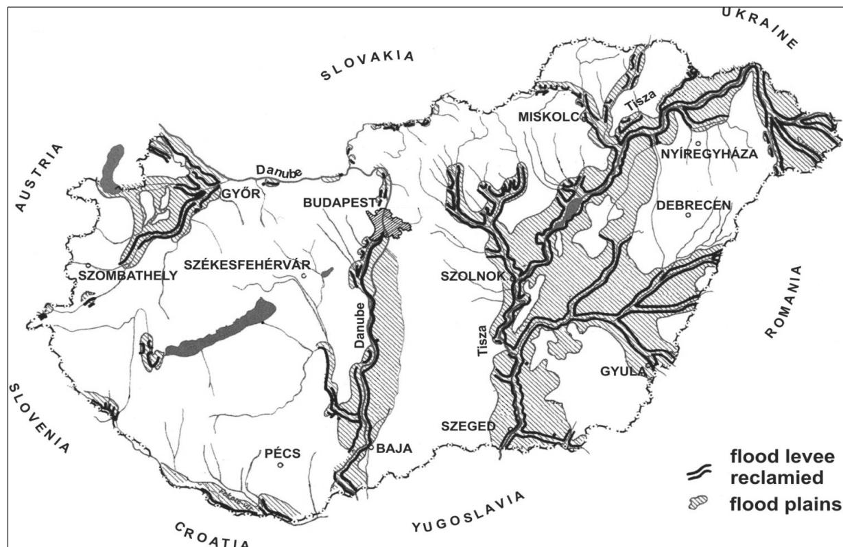
A térkép a **meglévő töltések**et az eddig mért legmagasabb árvízszinthez viszonyítva jelenti meg. A jelölt folyószakaszokon a töltések már elkészültek, a jelöletlen folyószakaszokon a gátak szintje a valaha mért legmagasabb vízszint alatt vannak.
